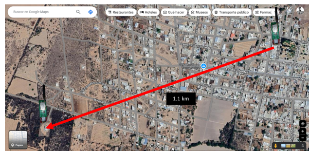
Figura 11: Prueba experimental de enlace LoRa B (1.1 km) en entorno urbano
